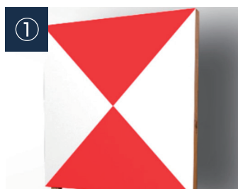
① 川の両岸に標定点を設置
